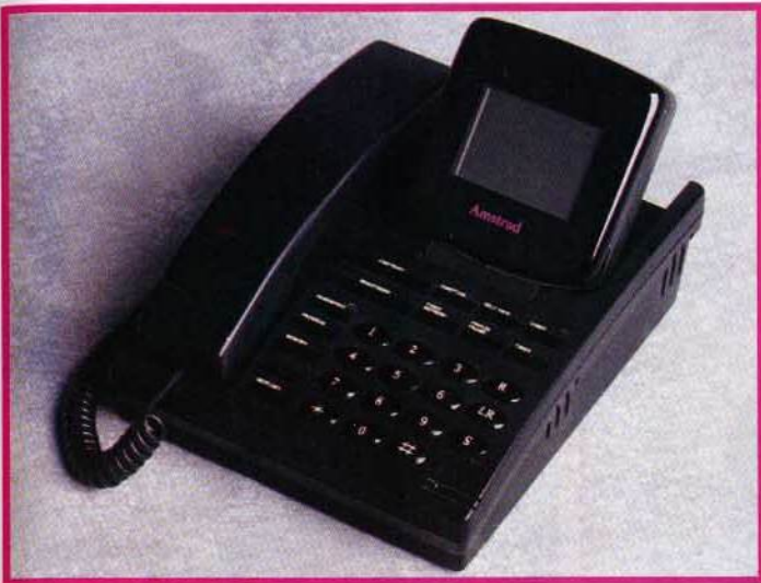
Amstrad attaque le marché de l'image par téléphone avec ce visiophone qui se branche sur une ligne téléphonique standard.
